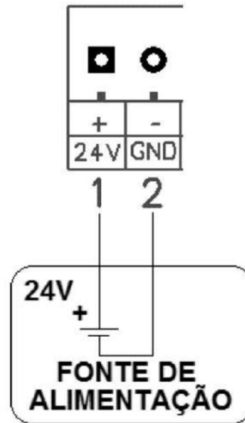
A alimentação deve ser realizada pelos bornes 1 e 2 conforme a imagem acima. A fonte deve ter tensão de 24V, capaz de fornecer no mínimo 200mA de corrente contínua.
