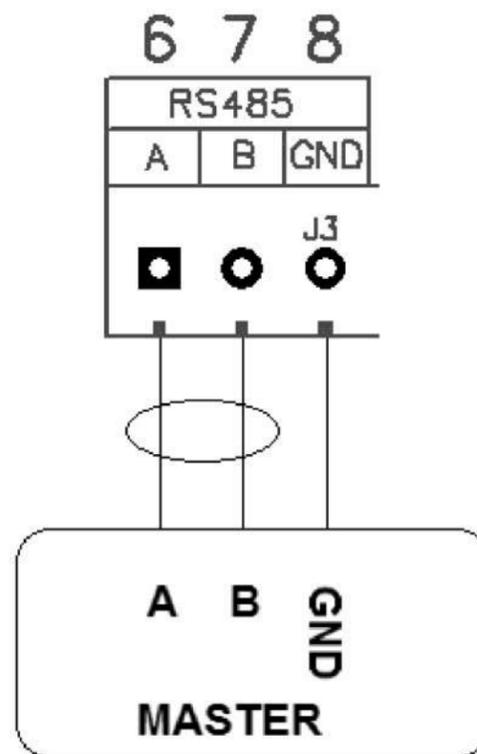
A conexão RS485 do módulo eletrônico é feita pelos bornes 5/6/7, a conexão é do tipo half-duplex, a codificação é realizada com base na norma IEEE-754.
