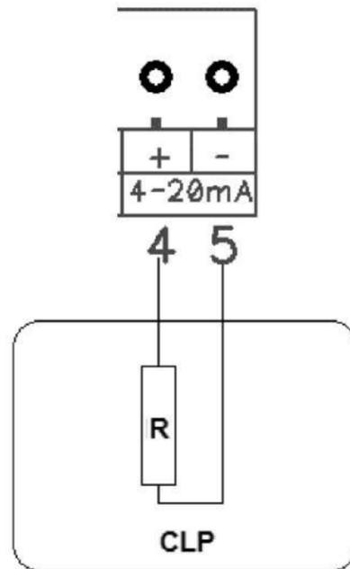
O sinal de corrente de loop (4 - 20m A) deve ser conectado ao CLP de maneira ativa, nota-se que **não é necessário a utilização de fonte em série**, o sinal de saída do **m módulo eletrônico é ativo**. A resistência interna do CLP deve ser inferior a 1k . A conexão de fonte de alimentação em série com o sinal de saída do módulo causará danos imediatos ao circuito analógico.
