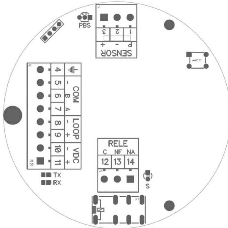
Figura 4: Descrição elementos módulos MGG-Radar-R-C
