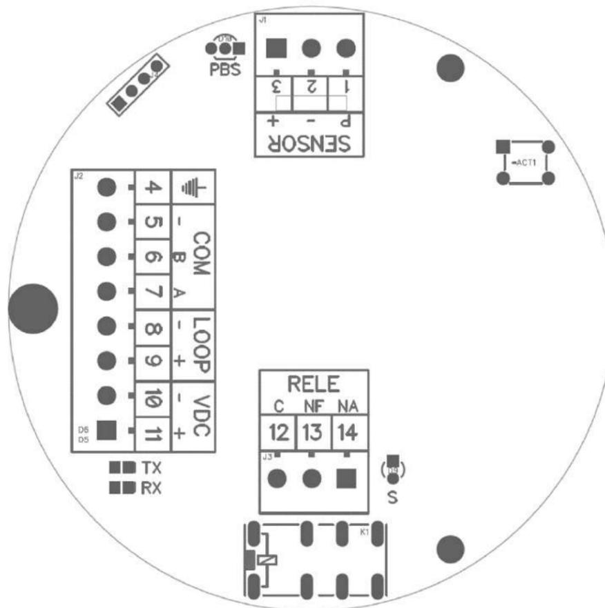
Figura 2: Descrição conexões MGG-Radar-R-C
