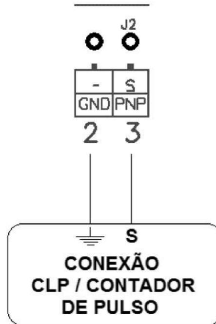
O sinal de saída de PNP deve ser conectado ao CLP / contador de pulso conforme a imagem acima, nota-se que não é necessário a utilização de fonte externa, pois o sinal de saída do módulo eletrônico é ativo. A largura do pulso é proporcional a distância medida pelo sensor ultrassônico, variando de 300 até 10000  $\mu$ s, este sinal é enviado a uma taxa de 0,58 Hz. O fator de conversão é de  $10 \mu$ s.cm<sup>-1</sup>.
